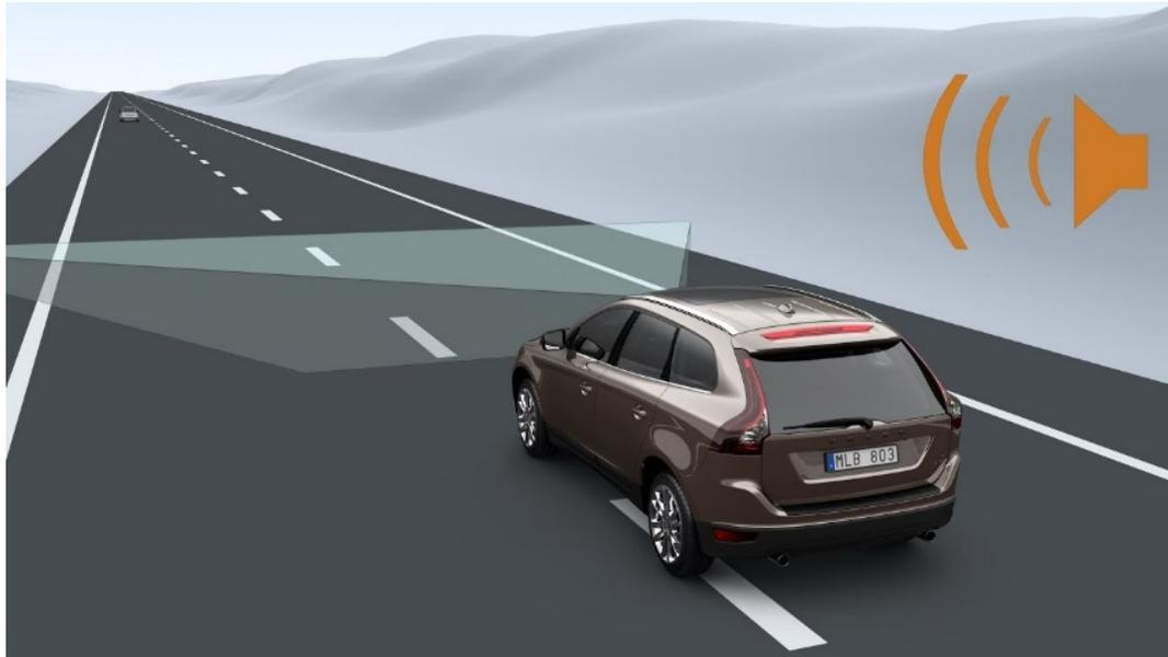
**Figura 11** Sistema Volvo de advertencia de cambio de carril, Volvo Cars AB (2018)
