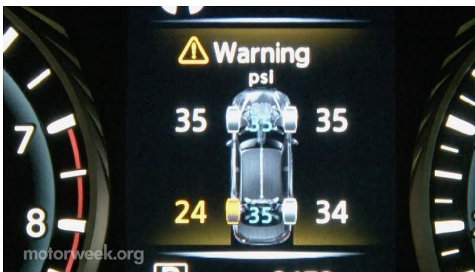
Figura 20 Alerta de Presión de Neumáticos, Volvo Cars AB (2017)
