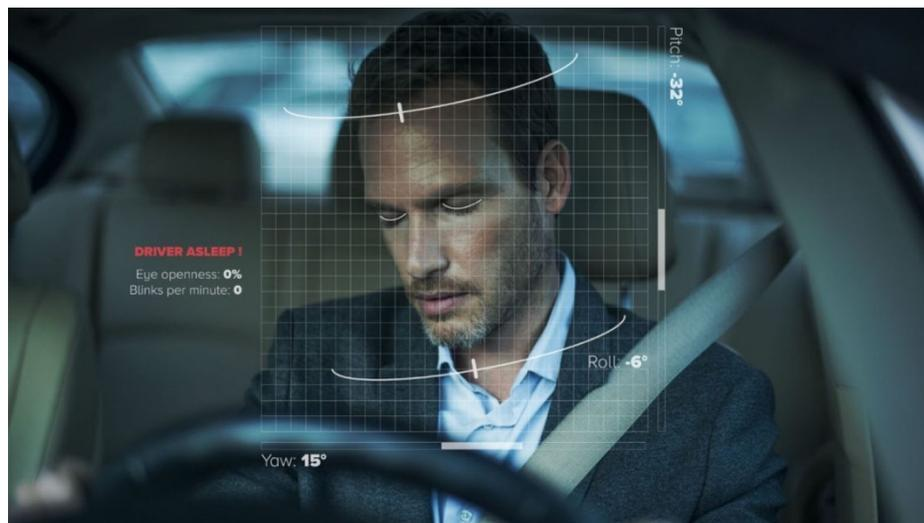
**Figura 21** Detección de Somnolencia del Conductor, Bosch (2018)
